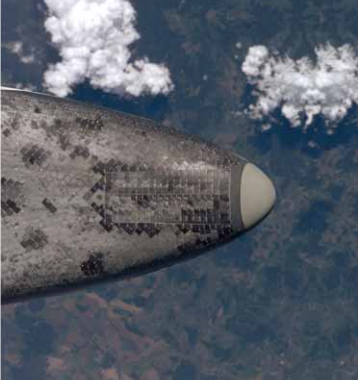
Keramisches Hitzeschutzschild Space Shuttle
